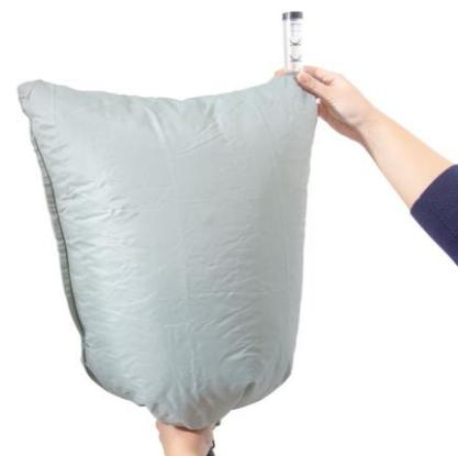
**7.3** Platzieren Sie die Gesichtsteil in den Strömungsmesserbeutel, und schalten Sie das Gebläse ein.
