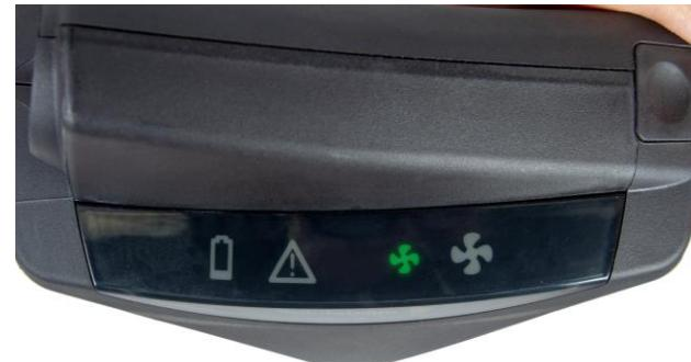
**6.3** Nach diesem internen Test erlöschen alle Symbole mit Ausnahme des kleinen grünen Gebläsesymbols. Das zeigt den Normalbetrieb mit einer Luftleistung von mindestens 175 l/min an.
