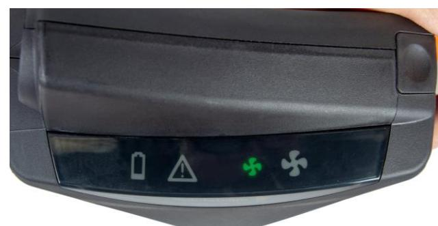
**8.3** Wenn der Auslass des Strömungsmessers freigegeben wird und somit die Luft wieder ungehindert fließen kann, hören die Alarmsignale nach 10–15 s auf.
