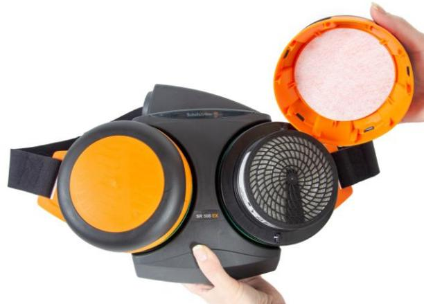
**5.4** Setzen Sie ein Vorfilter SR 221 in den Filterhalter ein. Schrauben Sie die Filterkombination so weit in die Filterfassung ein, dass das Filter an der Dichtung anliegt. Drehen Sie sie um etwa eine Achteldrehung weiter, um eine gute Abdichtung zu gewährleisten. Drücken Sie den Filterhalter auf das Partikelfilter.
