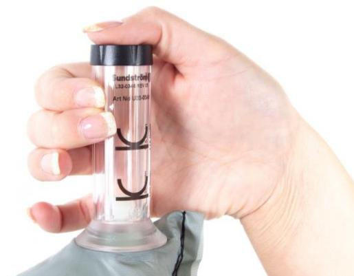
**8.1** Unterbrechen Sie die Luftzufuhr, indem Sie die Verbindung zwischen Schlauch und Strömungsmesserbeutel weiterhin halten, aber den Auslass des Strömungsmessers blockieren.
