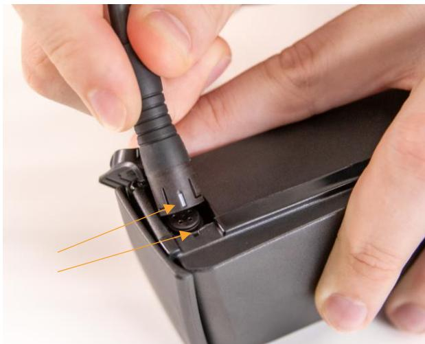
**1.4 Stellen Sie sicher, dass die weiße Markierung auf dem Stecker mit der Markierung am Batterieanschluss übereinstimmt.**
