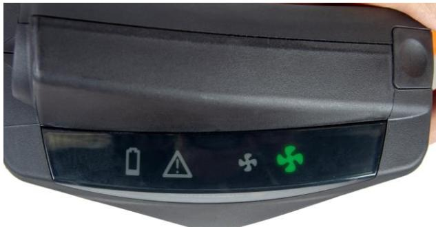
**6.4** Durch erneutes Drücken schaltet das Gebläse in den Volllastbetrieb mit mind. 225 l/min; es leuchtet das größere grüne Gebläsesymbol auf. Durch erneutes Drücken des Schalters wechselt das Gebläse wieder in den Normalbetrieb.
