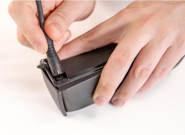
**1.3 Schließen Sie die Batterie an das Ladegerät an.**
