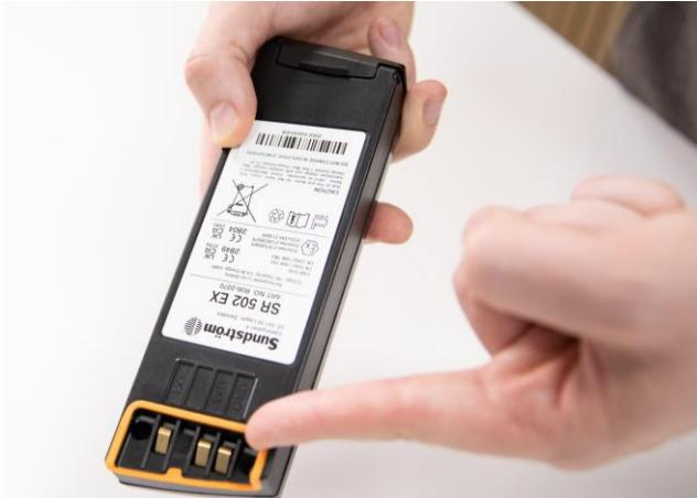
**2.1** Prüfen Sie vor Gebrauch des Gerätes, dass die Dichtung der Klappe über den Batteriepolen unversehrt ist. Entfernen Sie Schmutz auf der Batteriedichtung mit einem sauberen, trockenen Tuch. Fetten Sie für ein vereinfachtes Einsetzen die Dichtung neu mit Vaseline.
